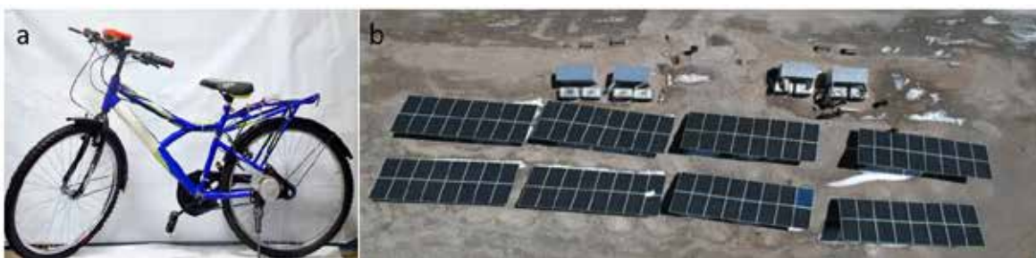
चित्र क) त्वरित चार्ज होने वाली ई-साइकिल (ख) सोलर फोटोवोल्टिक एरे और वीआरएफबी प्रणाली
