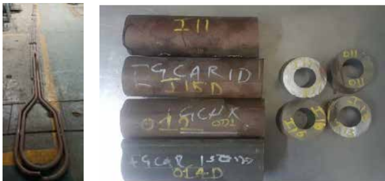
चित्र. अध्ययन के लिए एफएससीटीआर एनटीपीसी-दादरी साइट और ट्यूब नमूनों से एकत्रित टेस्ट लूप
