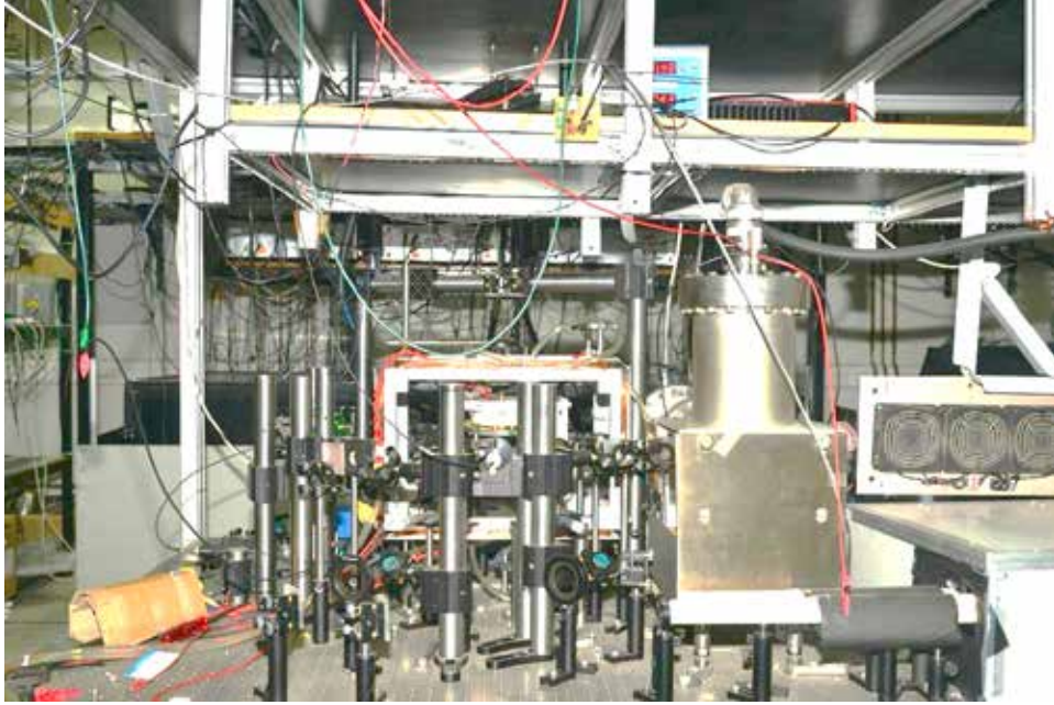
चित्र: प्रायोगिक प्रणाली जो उच्च परिशुद्धता के साथ 'जी' को मापती है
