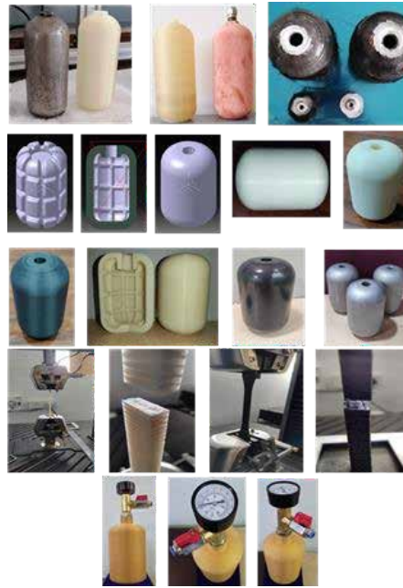
चित्र. विभिन्न अवस्थाओं और परीक्षण प्रक्रियाओं पर नमूना प्रोटोटाइप और सम्मिश्रित उच्च दबाव हाइड्रोजन भंडारण सिलेंडरों के मॉडल
