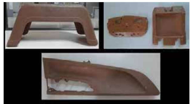
चित्र: प्राकृतिक फाइबर पीपी कंपोजिट से निर्मित लिग्नोसेलुलॉसिक फाइबर प्रबलित थर्मोप्लास्टिक कंपोजिट और उच्च अंत प्रोटोटाइप तैयार करने में शामिल चरण
