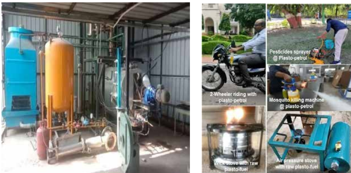
चित्र. वडोदरा रेलवे स्टेशन पर स्थापित थर्मो-कैटेलिटिक डिपोलीमराइजेशन संयंत्र और उत्पादित उत्पाद का विभिन्न अनुप्रयोगों में उपयोग करते हैं
