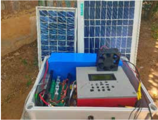
बेयरफुट कालेज तिलोनिया राजस्थान द्वारा आई ओ टी दायर कंट्रोलर प्रोटोटाइप
