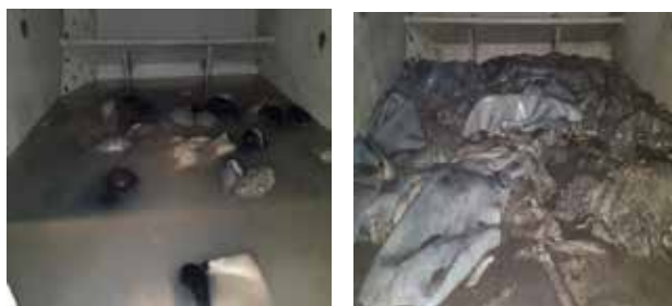
चित्र (क): मेसर्स फ्लेमिंगो एसएसआई, रानीपेट में ड्रम में 100% जल के साथ गौ-चर्म (ख) 100% जल, 2% चूने और सोडियम सल्फाइड के साथ 24 घंटे के उपचार के उपरांत गौ-चर्म पूरी तरह से बालों की सफाई दर्शाते हुए
