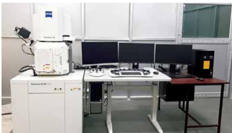
विश्व भारती विश्वविद्यालय, पश्चिम बंगाल में डीएसटी पर्स द्वारा सहायित ईडीएस सुविधाओं के साथ फील्ड एमिशन स्कैनिंग इलेक्ट्रॉन माइक्रोस्कोप
