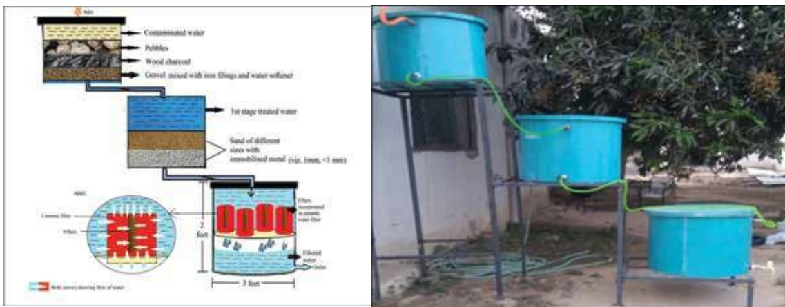
एकीकृत जलफिल्टर प्रणाली का आरेखण चित्र
