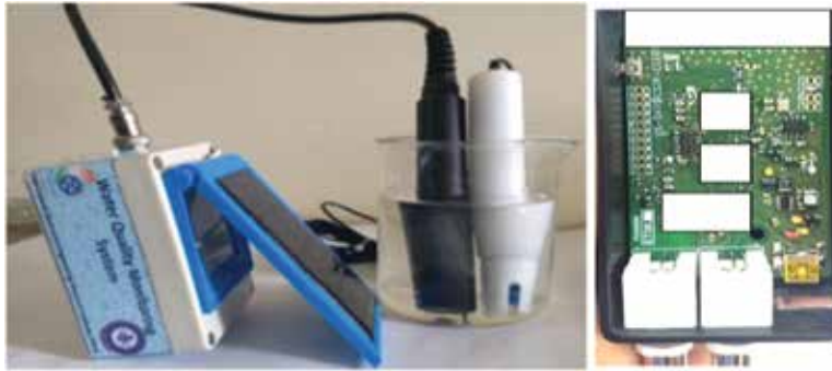
चित्र 8. सीएसआईआर-सीईईआरआई द्वारा विकसित हैंडहेल्ड बैटरी स्मार्ट जल की गुणवत्ता मापने वाला उपकरण
